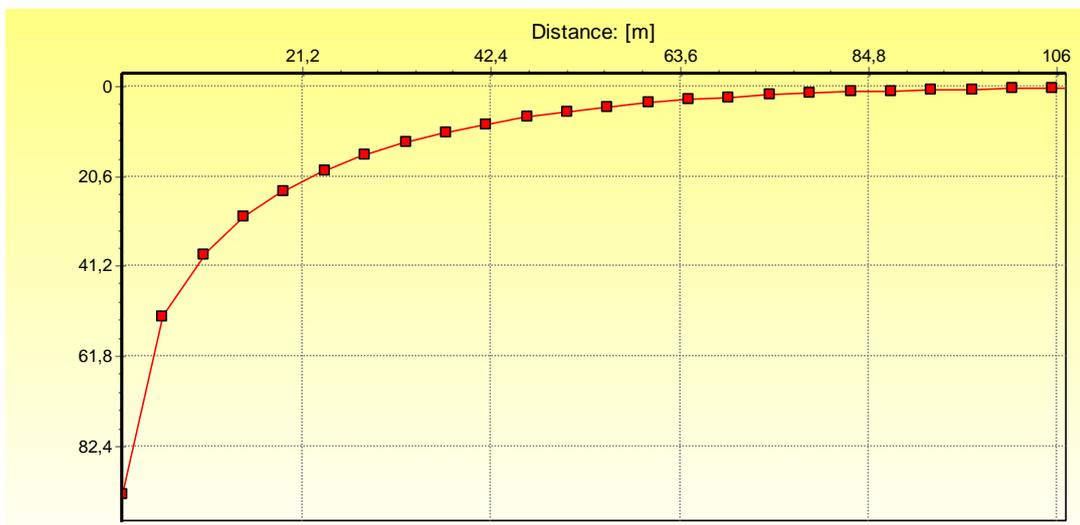
**Figura 04** – Gráficos de rebaixamento versus distância do raio do cone de depressão para um bombeamento de 24 horas consecutivas. O primeiro gráfico mostra o rebaixamento e a distância do raio para condição atual de operação do poço de Mina ( $Q = 8,08\text{m}^3/\text{h}$ ) e o segundo gráfico mostra a simulação de como seria o rebaixamento e a distância do raio para uma condição de operação de alta vazão ( $42,5\text{m}^3/\text{h}$ ) no mesmo poço, suficiente para secar o poço.
