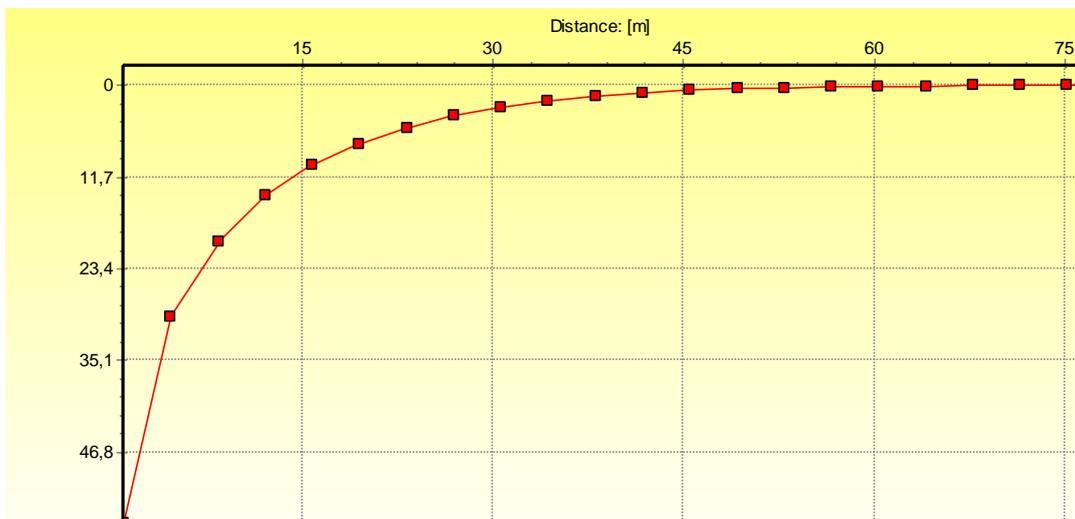
**Figura 05** – Gráficos de rebaixamento versus distância do raio do cone de depressão para um bombeamento de 24 horas consecutivas. O primeiro gráfico mostra o rebaixamento e a distância do raio para condição atual de operação do poço de Alvorada ( $Q = 15,25\text{m}^3/\text{h}$ ) e o segundo gráfico mostra a simulação de como seria o rebaixamento e a distância do raio para uma condição de operação de alta vazão ( $225\text{m}^3/\text{h}$ ) no mesmo poço, suficiente para secar o poço.
