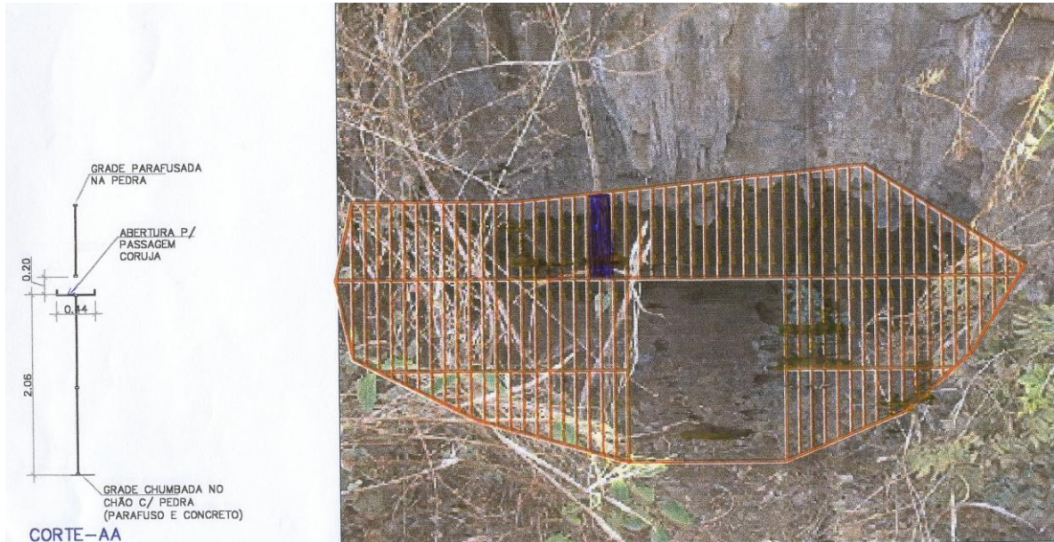
Anteprojeto de grade para a entrada da Gruta Lagoa Rica, Paracatu, MG.
