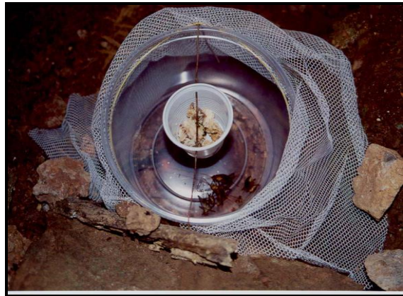
Fig. 8. "Pitfall" interno envolvido por filó. Foto: Franciane Jordão da Silva. Acervo: Cecav/Ibama.
