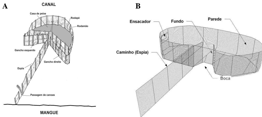
**Figura 03** – Desenho esquemático da estrutura do (A) cerco-fixado e do (B) cerco-flutuante.
