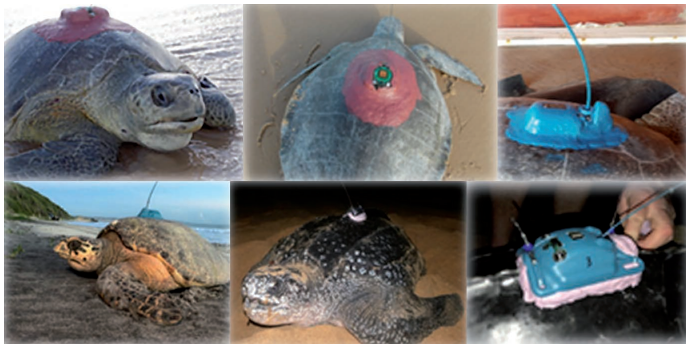
Figura 3 (III): Exemplos de transmissores instalados em tartarugas marinhas e uso mínimo de material de fixação para reduzir o arrasto hidrodinâmico. Fonte: Acervo Centro TAMAR/ICMBio.
